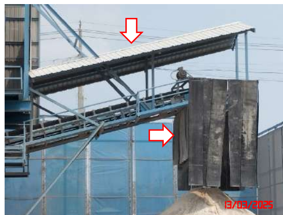
หลังคาปิดคลุมและถุงคลุมสายพานลำเลียง
